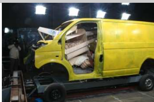
Résultat d'un crash-test réalisé avec des étagères « maison »
