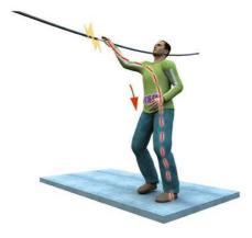
En règle générale, le courant électrique retourne toujours au générateur qui lui a donné naissance, même par des voies détournées, notamment la terre. C'est ainsi qu'un homme relié à la terre, indirectement par ses chaussures ou par l'intermédiaire d'un corps conducteur (charpente métallique, conduite d'eau...), risque l'électrocution s'il entre en contact avec un conducteur nu sous tension.
