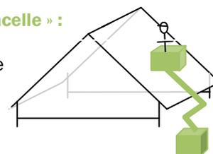
Dans certains cas l'intervention ne pourra pas être réalisée depuis une PEMP (urgence ne permettant pas de louer une nacelle, nature de l'activité), elle devra donc être réalisée directement depuis le toit. L'accès au toit doit être sécurisé par la mise en place de protections individuelles. Ce type d'intervention ne peut-être réalisée par un agent seul.
