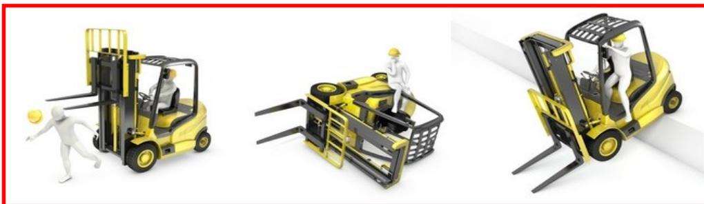
Le conducteur **adapte le poste de conduite** à sa morphologie et s'assure du bon fonctionnement de l'ensemble des dispositifs de sécurité. Il respecte **les règles de conduite** (cheminement, vitesse, pas de consommation d'alcool ou de médicaments, pas de téléphone portable ou d'écouteurs, le cas échéant port de la ceinture de sécurité, etc.) et le mode opératoire prévu.
